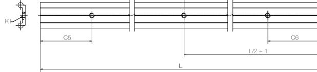
AWS® W 特殊导轨, 带 3 个3/8" 螺纹孔
